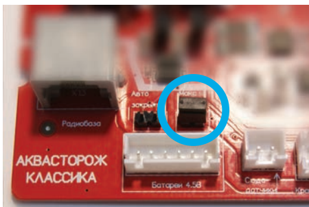
Максимальная чувствительность - перемычка установлена
