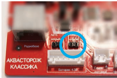
Минимальная чувствительность - перемычка удалена
