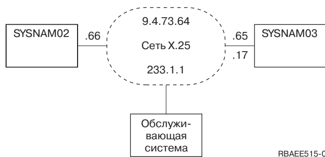
Рисунок 52. Сеть TCP/IP с хостом с несколькими IP-адресами
