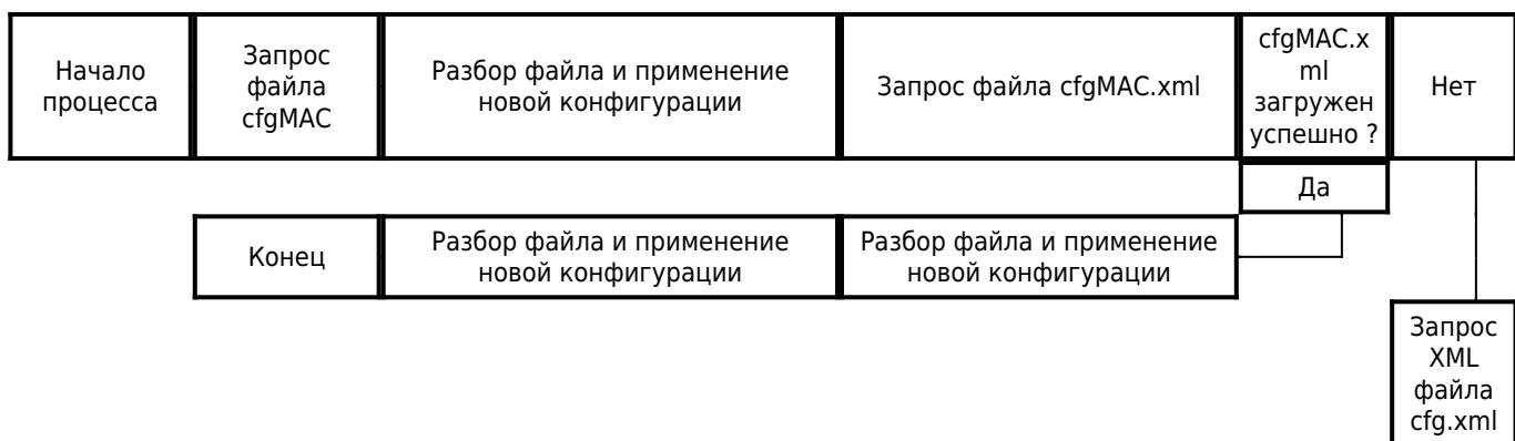
Обратите внимание, что настройки будут применены после загрузки файла cfgMAC. Это означает, что сервер настройки подготовки к работе (Provisioning) может перенаправить устройство на XML сервер без перезагрузки. Это может быть использовано для передачи зашифрованных паролей XML.
