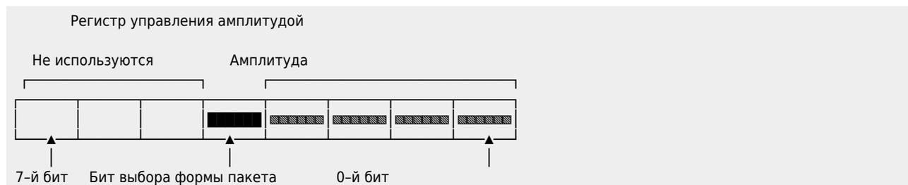
При этом в четвёртый бит попадает единица, в младшие биты — нули (старшие три бита не используются), следовательно, все установленные значения амплитуд сбрасываются. При выполнении же команды V (параметр V находится в диапазоне от 0 = 0000<sub>2</sub> до 15 = 1111<sub>2</sub>) значение четвёртого бита всегда будет сброшено на 0.
