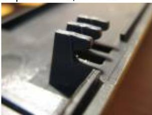
Также возможно использования плоской отвертки для открытия защёлок. Для этого нужно вставить отвёртку в щель под защёлкой, чуть раздвинуть корпус пальцами, аккуратно отжимая защёлку отвёрткой. Начинать лучше с одного края и сначала открыть обе защёлки с одной стороны, а затем перейти на другую сторону.
