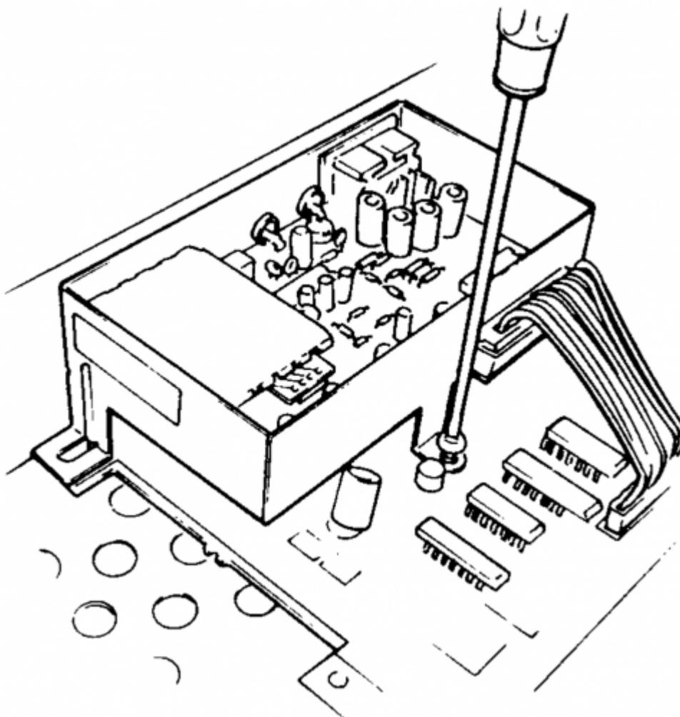
3. Аккуратно отогнуть заднюю стенку с отверстиями для разъёмов и снять видеомодуль, как показано на рисунке:
