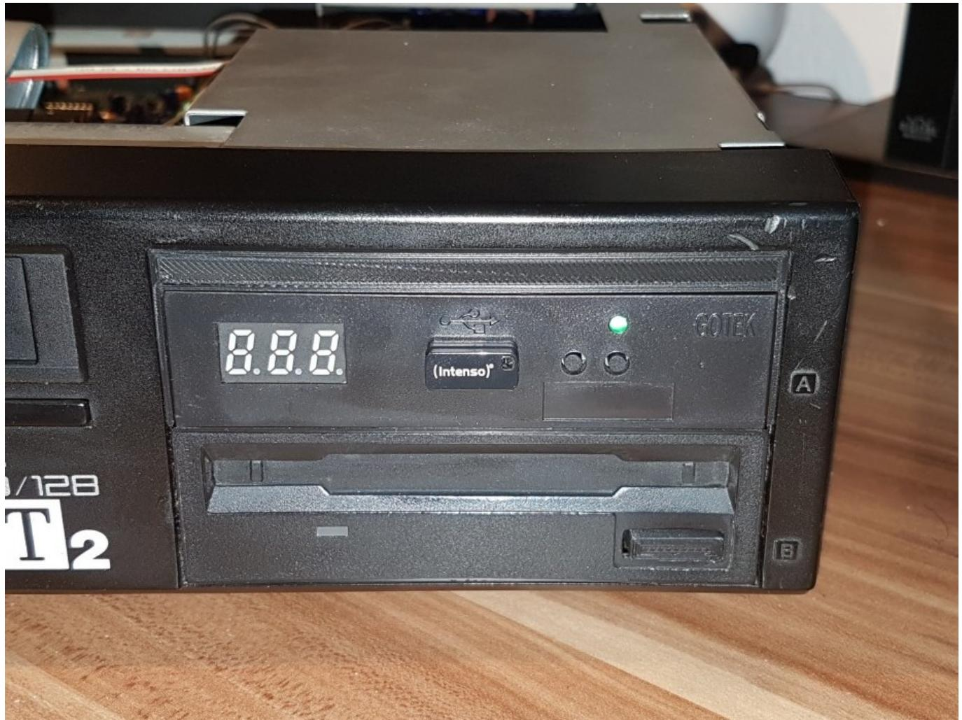
После установки включите компьютер и убедитесь, что вы можете загрузиться с образа диска (файл .DSK), расположенного на USB носителе. Если компьютер загружается только в MSX BASIC, введите команду `files`, чтобы отобразить содержимое подключённого образа диска. Если образ диска не читается, проверьте, правильно ли подключён эмулятор [GoTek](#) к материнской плате - подключены должны быть кабель питания и кабель интерфейса. Также убедитесь, что используемый образ диска не содержит ошибок.
