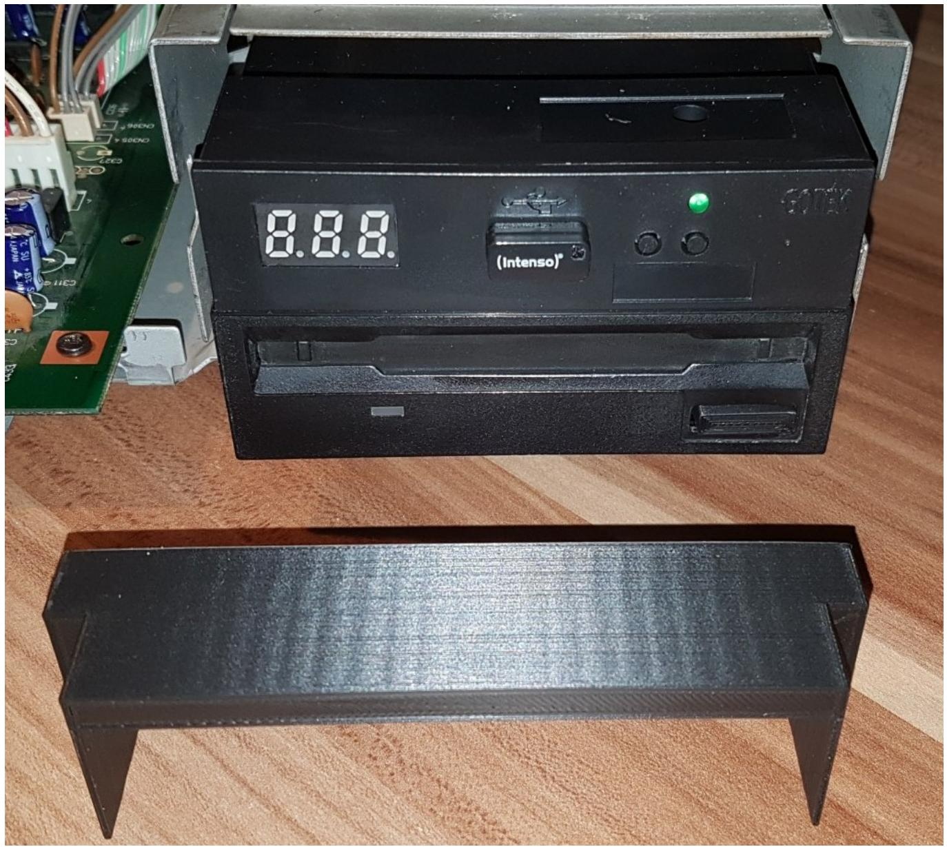
Проставка, напечатанная на 3D-принтере устанавливается сверху корпуса GoTek, а затем передняя панель крепится к корпусу MSX, чтобы между корпусом эмулятора и передней панелью не было зазоров. На фотографии ниже видно правильно установленный эмулятор дисковода.
