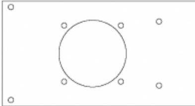
Чертеж крышки для вентилятора (dxf), сделан в [LibreCAD](#).
