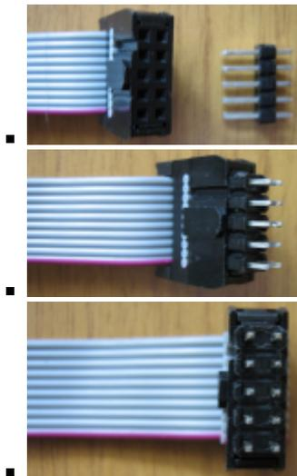
Затем разъём программатора нужно вставить в разъём AS картриджа и чуть наклонить его, чтобы обеспечить хороший контакт «гребёнки» с платой:
