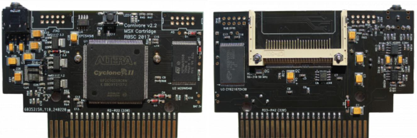
Примечание: на плате производства Machiol некоторые танталовые конденсаторы были заменены на керамические, также аудиоразъём перенесён на обратную сторону платы.
